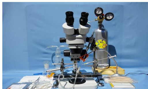
شکل ۱. دستگاه گردآوری و تلقیح مصنوعی منی
